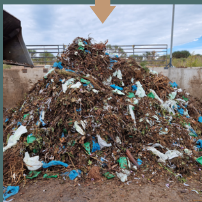
Fig. 5 Introduction des matériaux compostables (1,3%) dans le lot « TEST » : avant et après mélange
